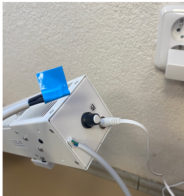
Obr.2 Zapojení teplotního senzoru
