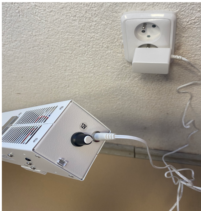
Obr.1 Zapojení adaptéru
