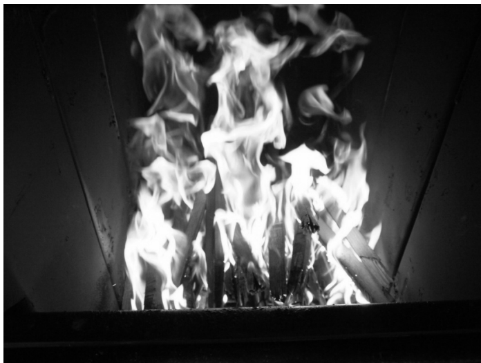
Obr. 11 Dostatečně rozhořená základní vrstva
