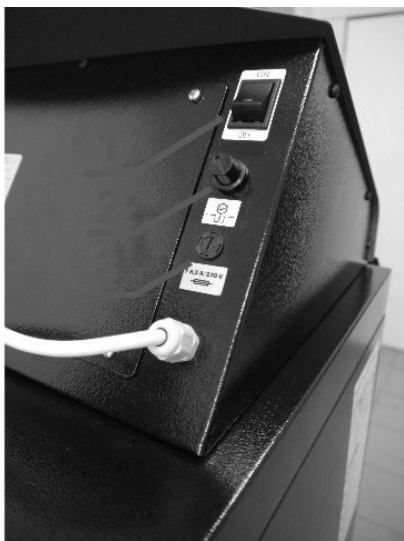
Obr. 17 1 – hlavní vypínač, 2 – havarijní termostat, 3 – pojistka (F6,3A)
