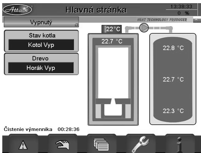
Obr. 21 Po zvolení režimu TEST se na dolní liště, zobrazí symbol ruky, kde je možné otestovat všechny elektrické zařízení připojené k elektronice
