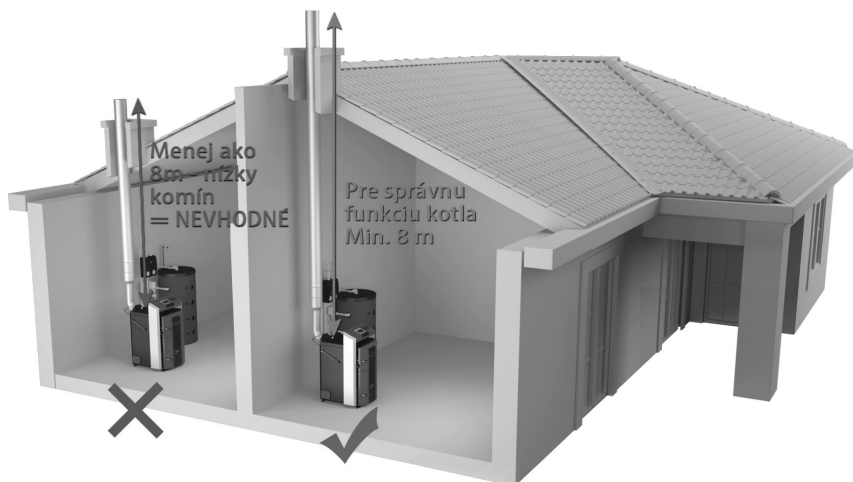
Obr. 3 Správne a nesprávne parametry komínu pro připojení kotle SLX
